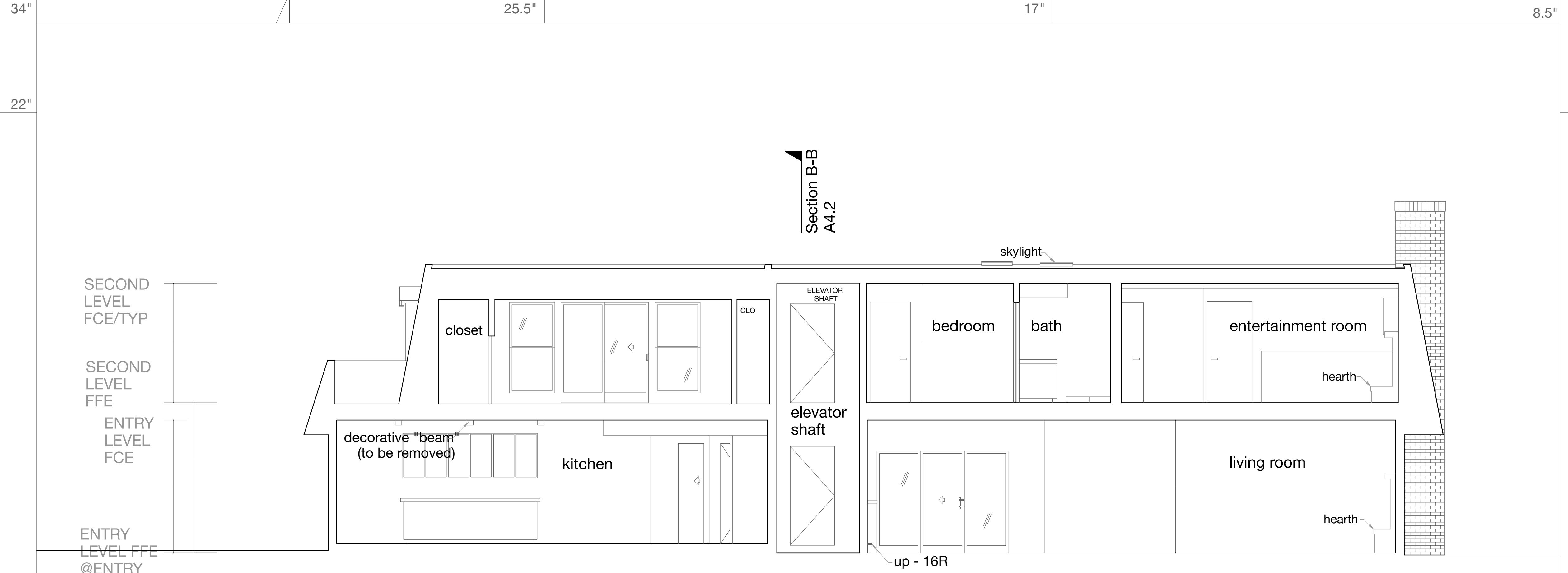
Existing Longitudinal Section A-A
